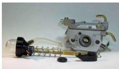
4. 用原本的弹簧和胶环将新的泵油组件装配好
