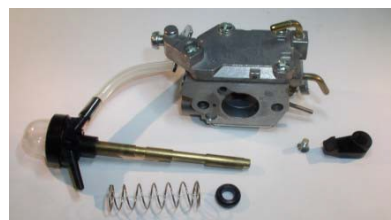
4. 用原本的弹簧和胶环将新的泵油组件装配好
