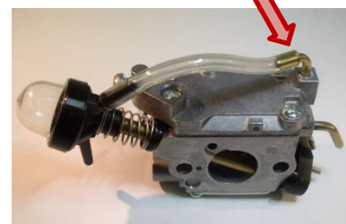
6. 将胶管连接到铜管上
